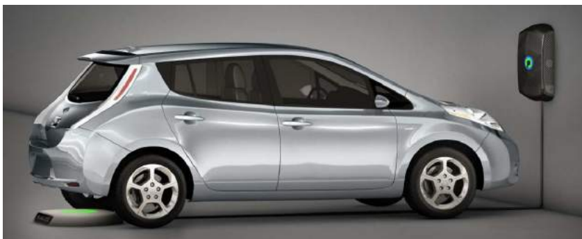
Figuur 2: het statisch inductief laadpunt dat Plugless Power aanbiedt
